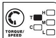
Task-Mode: Herunterschalten und Reduzieren der Rotations- und Aufprallgeschwindigkeit vor dem Eintreiben der Schraube.
