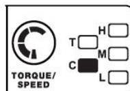
Cruise-Mode: Festlegung einer konstanten Geschwindigkeit. Dieser Modus ist ideal für sensible Anwendungen mit gleichbleibender Geschwindigkeit.
